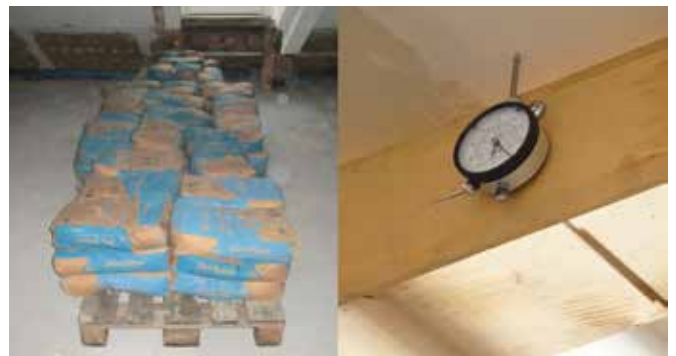
Bild 14: Belastungsversuch der Holz-Beton-Verbunddecke
