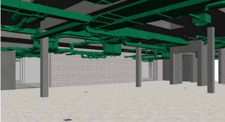
Bild 5: Tragwerks- und Haustechnikmodell
