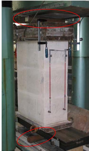
b) Lagerung des Versuchskörpers unter exzentrischer Belastung
