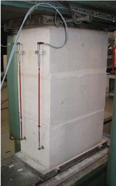
a) Lagerung des Versuchskörpers unter zentrischer Belastung
